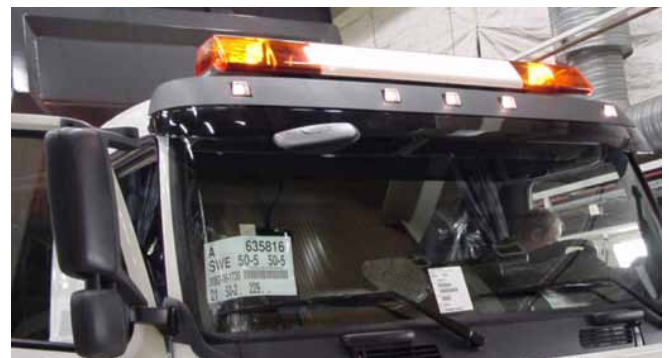
Gyrophares actionnés lorsque la prise de force est enclenchée, quelle que soit la position de l'interrupteur.
